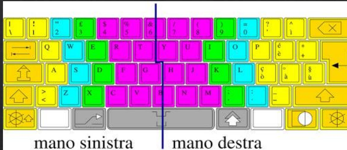
La posizione di base viene individuata nella seconda fila dei tasti di scrittura ,e prende il nome di **riga di base** o **rigo base**.
